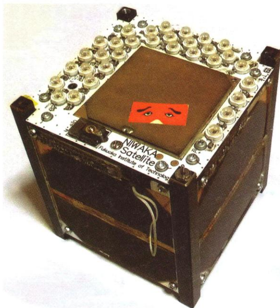
〈写真2〉 FITSAT-1の底面（-Z面）：1.2 GHz帯パッチ・アンテナ、赤色LED、後方カメラ；p.77）
