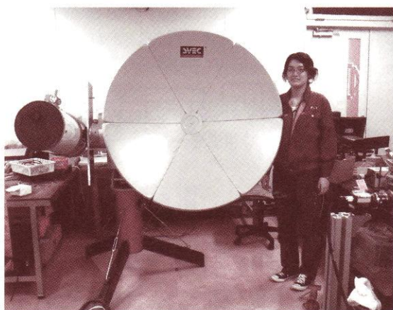
〈写真13〉 経緯台に取り付けたパラボラ・アンテナ(直径1.2 m)
