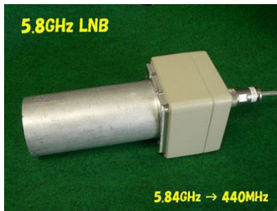
図2 6 : LNB (周波数コンバータ)
