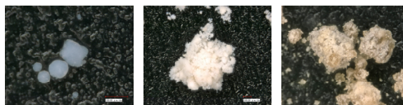
廃液中の微粒子 ろ過助剤 A 微粒子を捕集した A 図3 濾過助剤による微粒子捕捉
