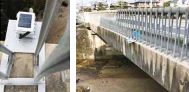
IoT洪水予測: 従前の1/10のコストで河川の水位計測
