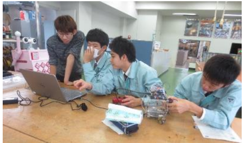
課題研究は「Arduinoを用いた遠隔操作ロボットの製作」です。PS3用ワイヤレスコントローラからBluetoothを用いて無線通信でArduinoにデータが入力されます。得られたデータを処理して、車輪用モータやカメラ用2軸ステージを動かし、ロボットを移動させたり任意の方向の映像を取得したりします。カメラの映像はWi-Fiを用いてiPadで見ることができます。
