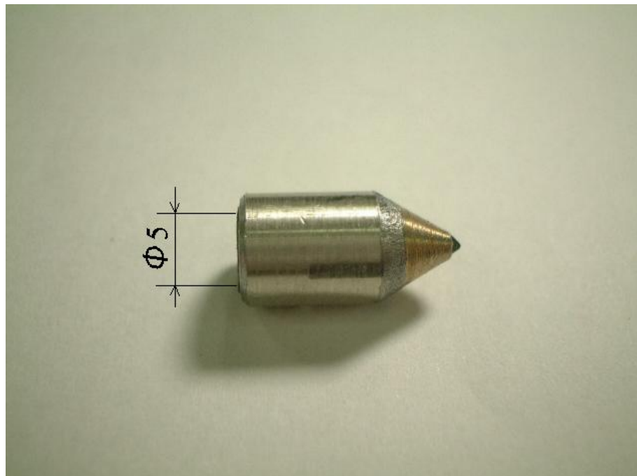
b) レーザーのターゲットとして加工後のダイヤモンドドレッサー 5軸加工台に取り付け可能になっている、詳細は付録に示す
