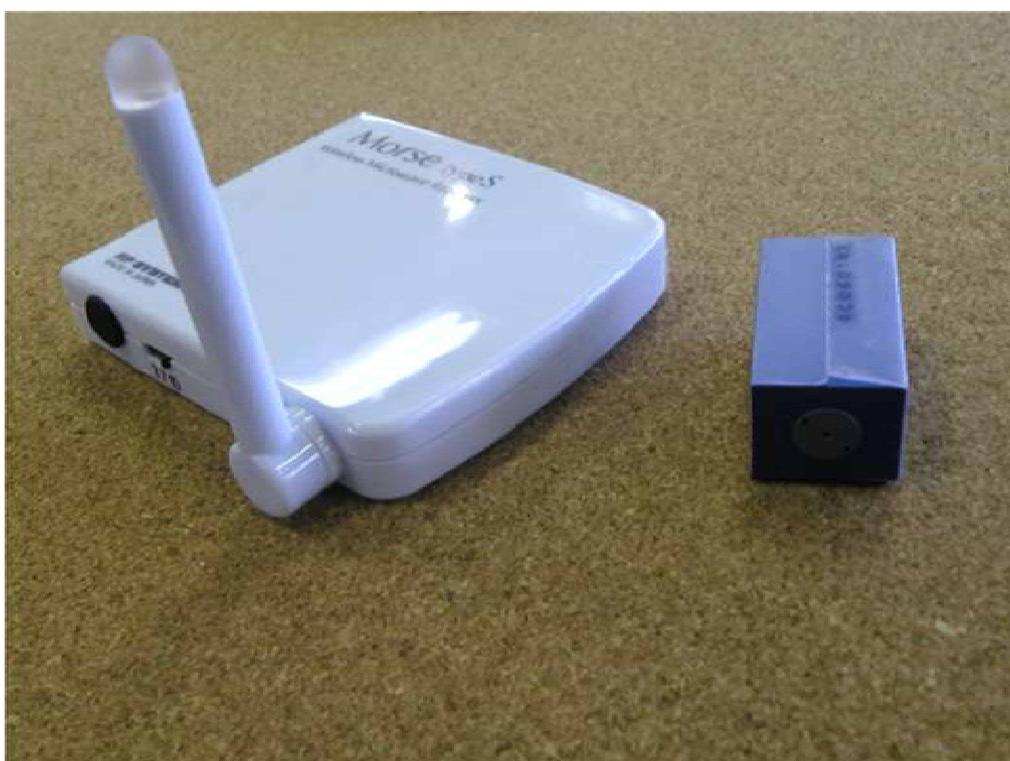
図 6-1 送信機内蔵小型カメラとその受信機
