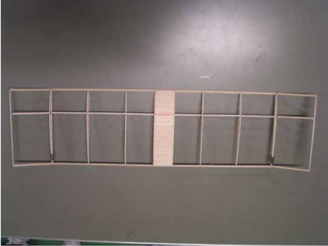
図 2-3 主翼骨組み
