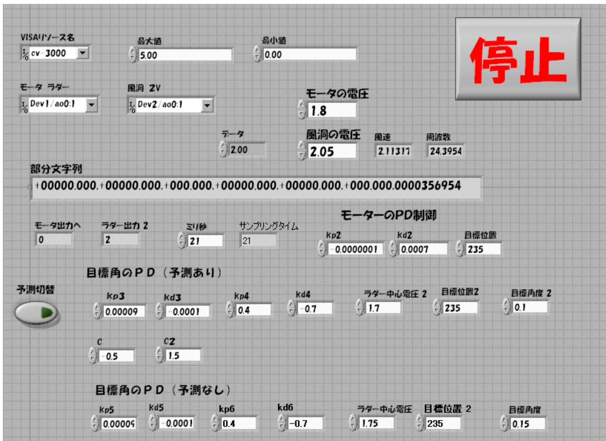
図 20 飛行制御プログラムのフロントパネル
