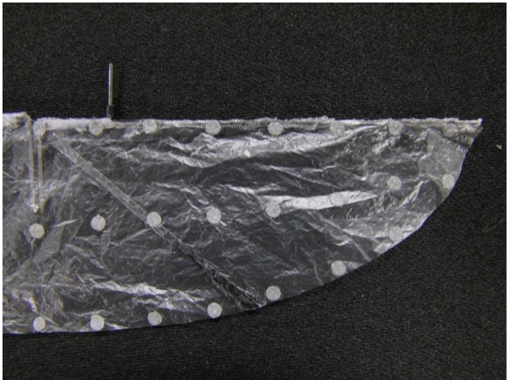
図 3.2 翼膜 (翼支骨あり)
