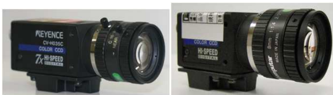
図. 2.2 CCD カメラ： CV-35C 7倍速タイプ（左） CV-35C（右）
