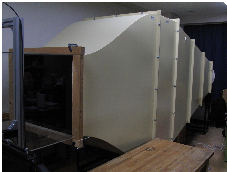
図. 2.5 大型低速風洞
