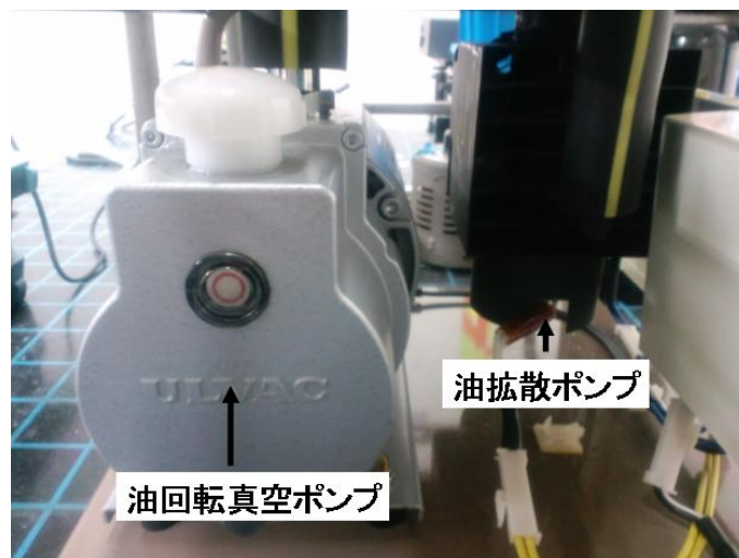
図 3.4 高真空ポンプ側面
