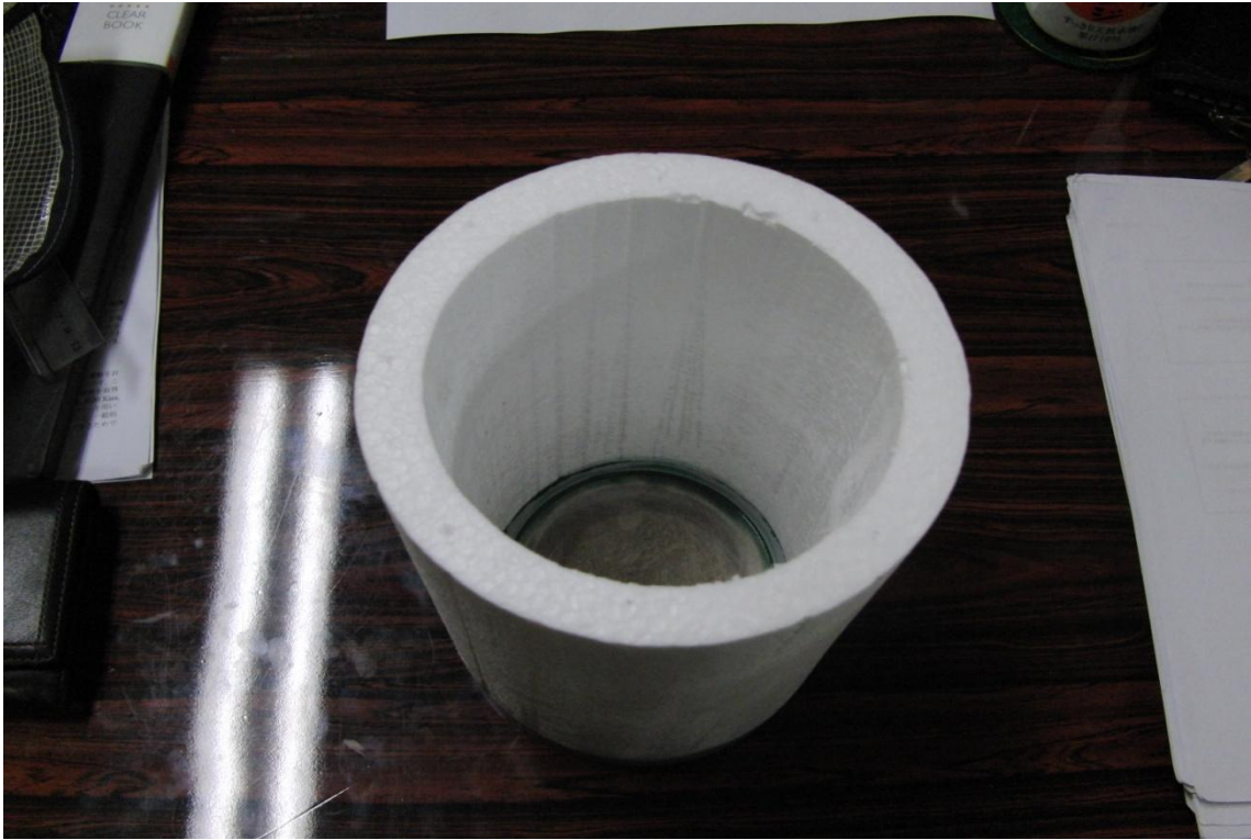
图 2.7 热源容器上部
