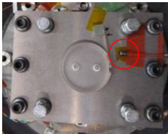
図7 治具の加速度ピックアップの取り付け位置 (Z軸のみ)
