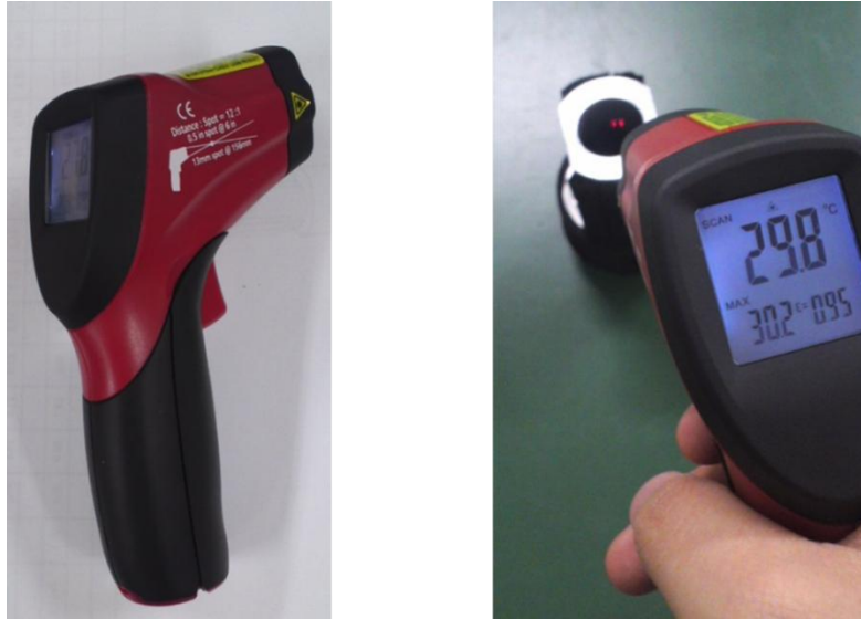
図 2.11 放射温度計（ -50^{\circ}\text{C} ～ 550^{\circ}\text{C} ）と測定の様子
