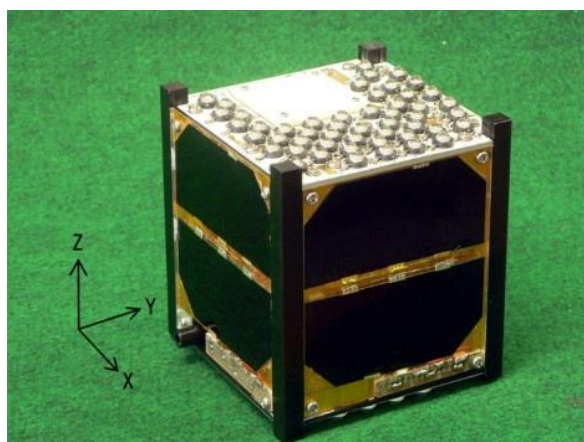
図3.1. 供試体 (FM) の外観及び座標系
