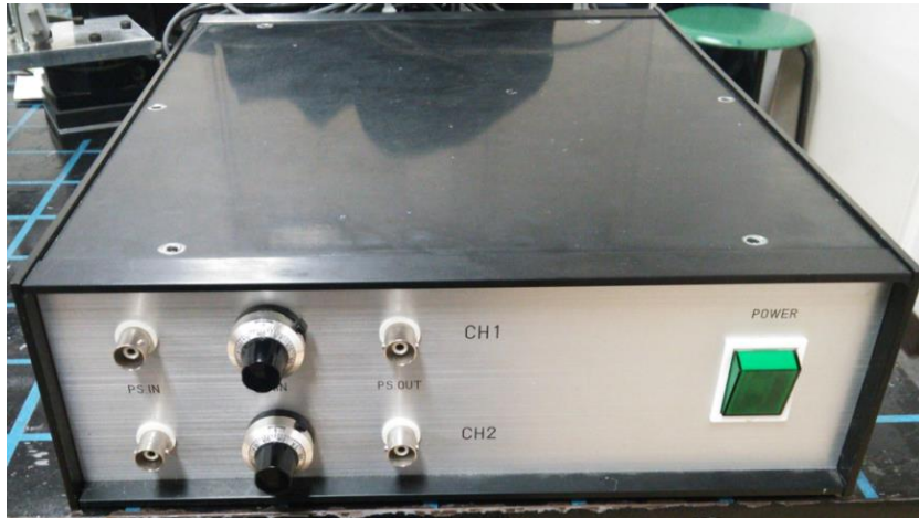
図 2.14 ガルバノミラー制御ボックス
