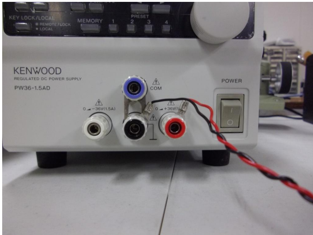
電源装置側モータドライバー接続
