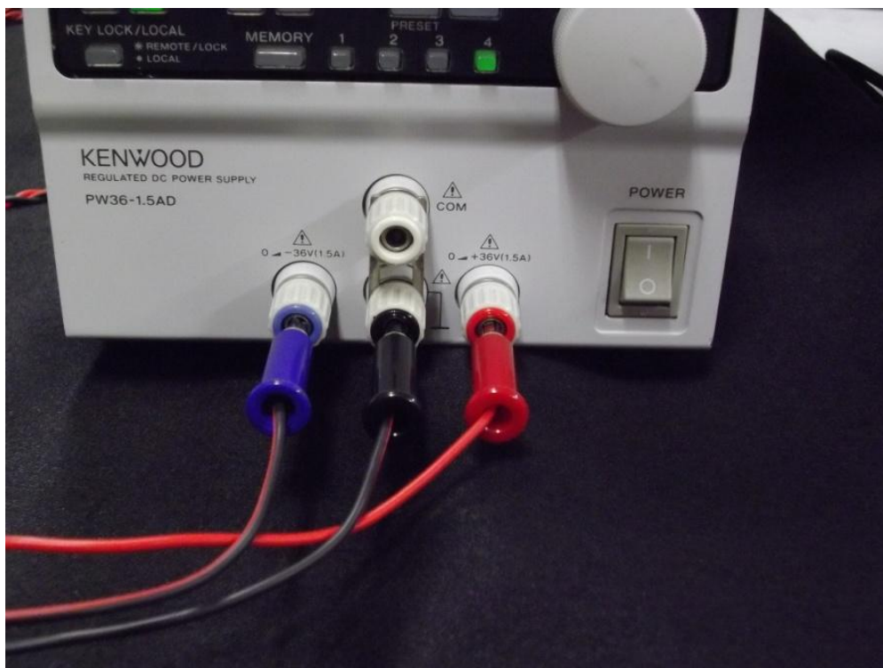
電源装置側 VF コンバータ接続
