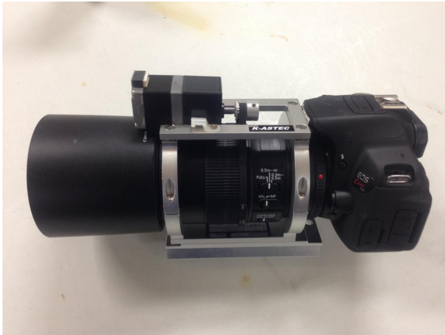
図 5.6 カメラ(EOS Kiss X6i) f=100\text{mm} 口径 \phi 67\text{mm} レンズ装着
