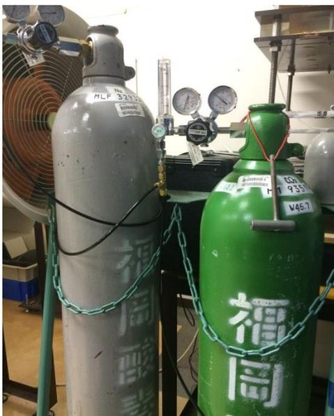
Fig.2.13  $\text{N}_2$  ボンベ(左)と  $\text{CO}_2$  ボンベ(左)
