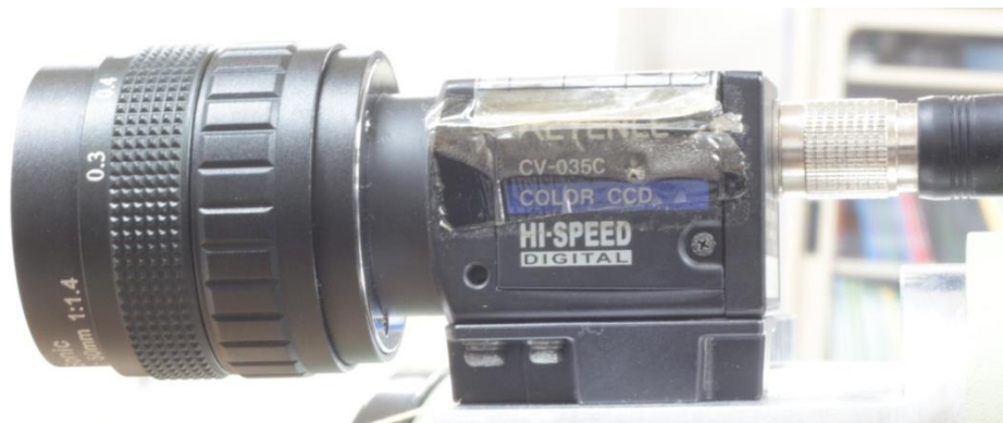
図 2.2 CCD カメラ及び C マウントレンズ
