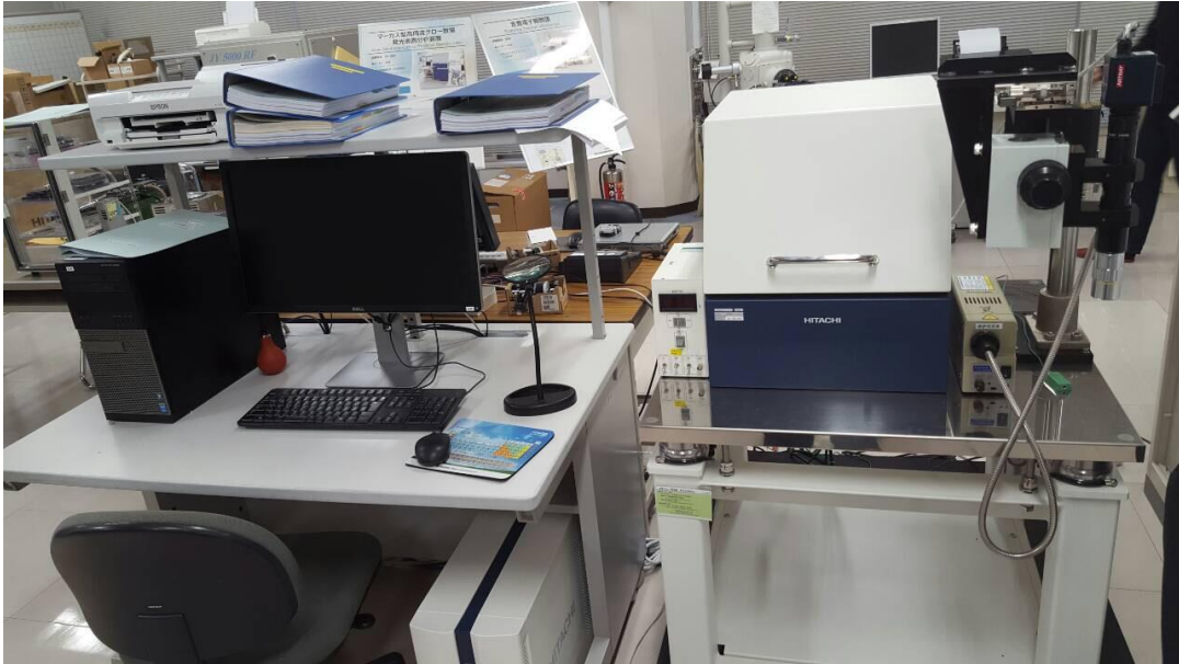
原子間力顕微鏡(AFM) ステージユニット AFM5200S プローブステーション AFM5000 II
