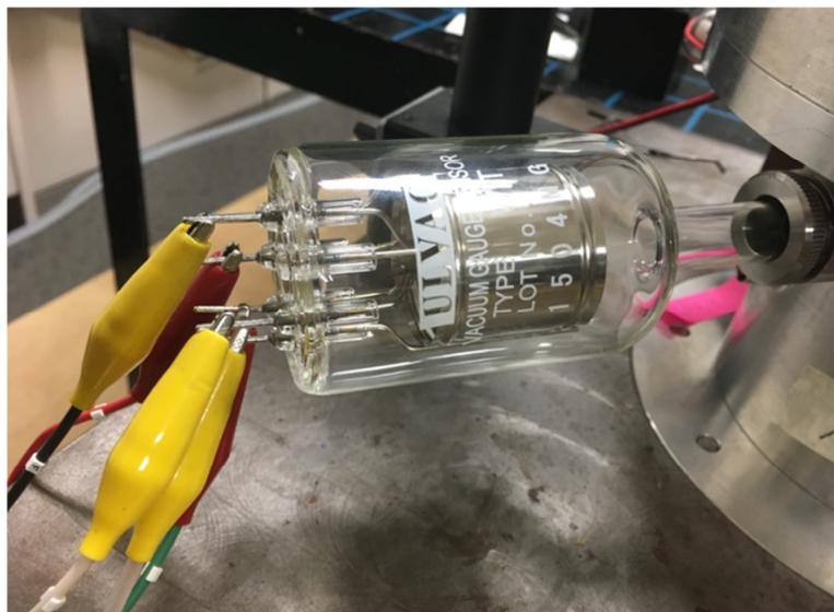
図 2-14 電離真空ゲージ部の概観
