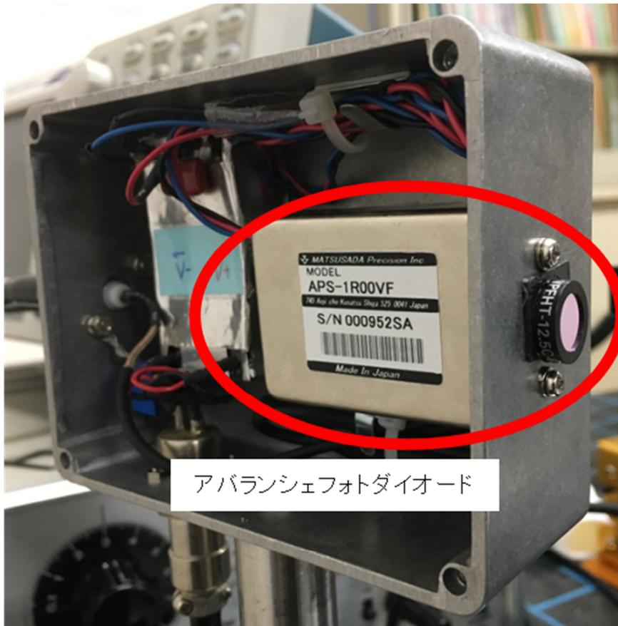
図 3-2 アバランシェフォトダイオードの概観
