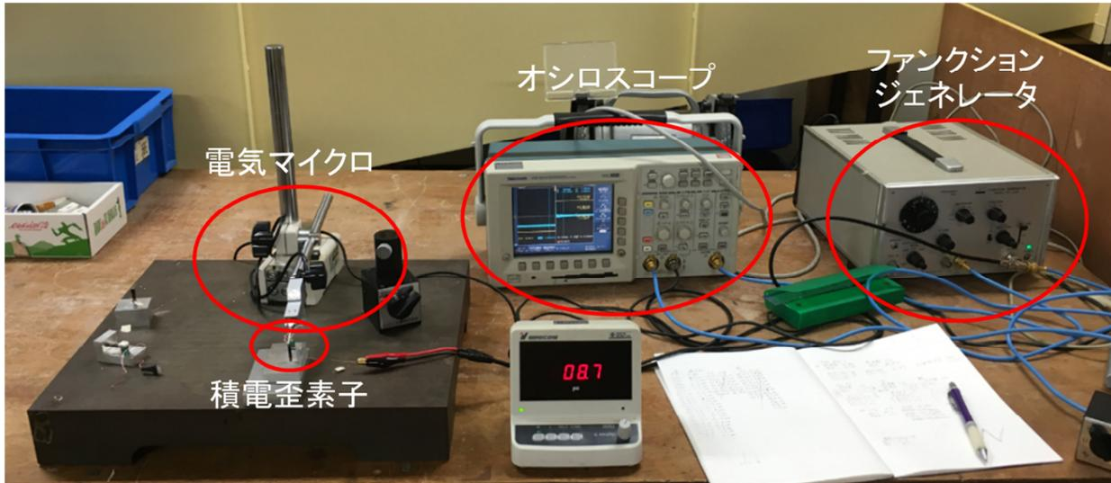
図 4-5 積層電歪素子の評価実験の概略
