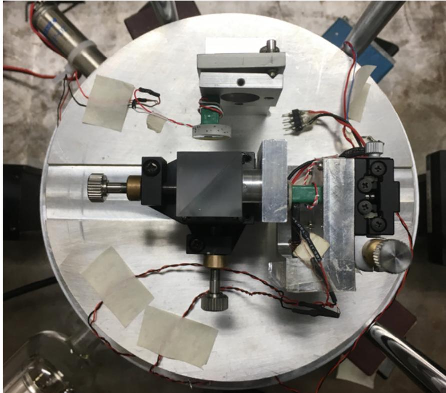
図 2-2 マイケルソン干渉計の概観
