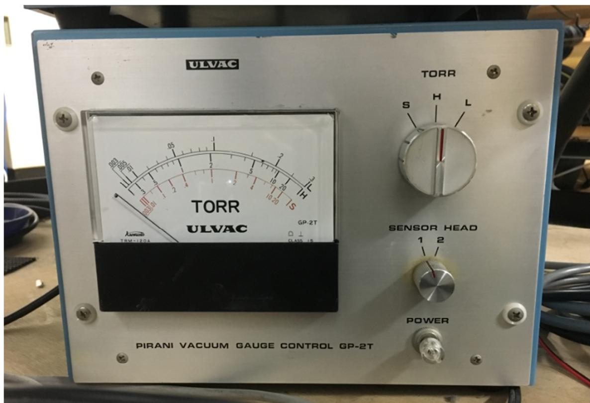
図 2-12 ピラニ真空計の概観
