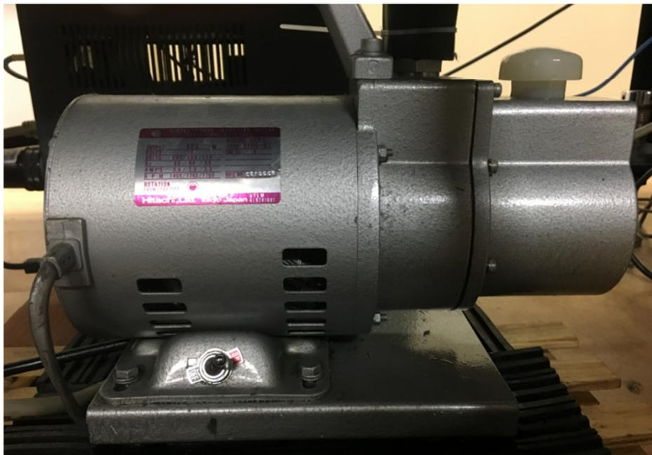
図 2-8 ロータリーポンプの概観
