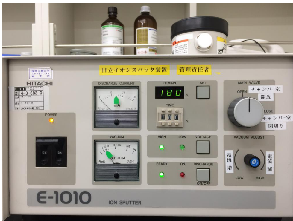
図 2.1 イオンスパッタリング装置の外観
