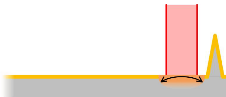
図 7.1 レーザー光によるマイクロ片持ち梁の膨張の概要。
