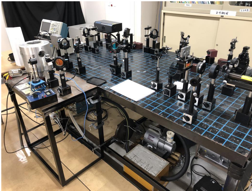
図 5.8 微小ファブリ・ペロー干渉計を用いた振動計測システムの全体外観
