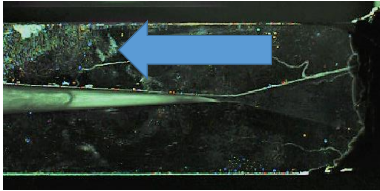
図 5.3 1000fps シャッタースピード open で撮影したノズル内部の写真
