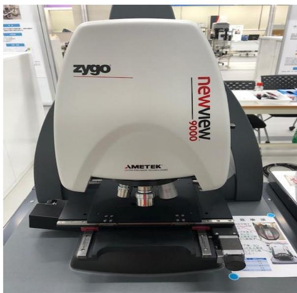
図 2・8 3次元光学プロファイラー
