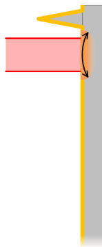
図 4.3 レーザー光による微小片持ち梁の膨張の概要
