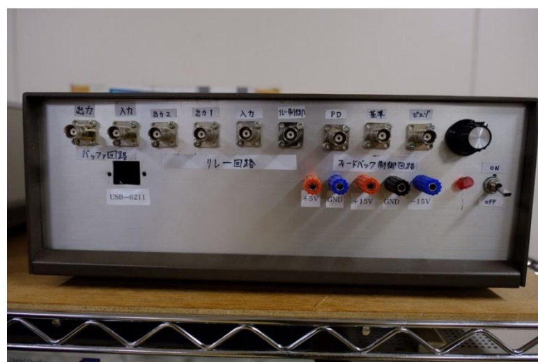
図 2.7.1 安定化回路, 反転バッファ回路の外観
