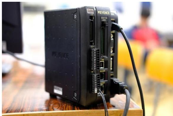
図 2.8 マルチカメラ対応超高速デジタル画像センサ外観
