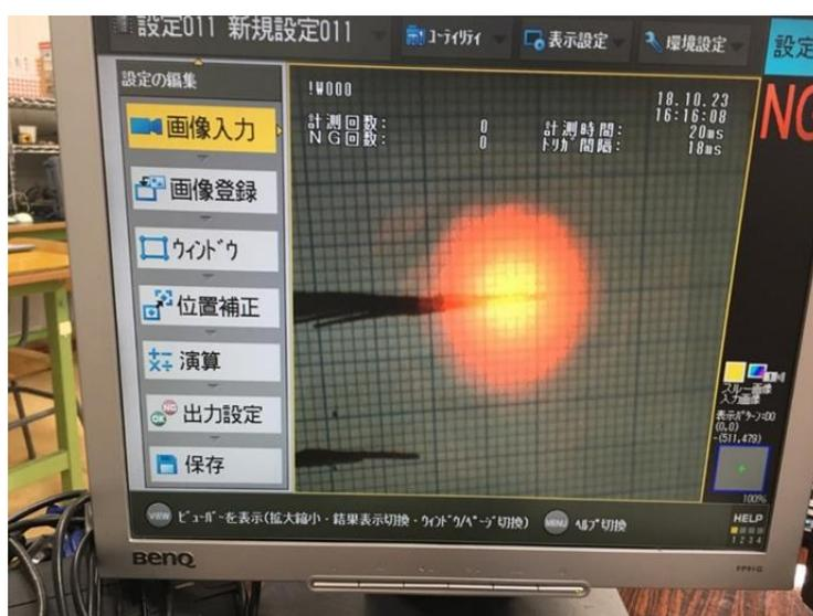
図 5.2 マルチカメラ対応型高速デジタル画像センサのレーザー光の追従画面
