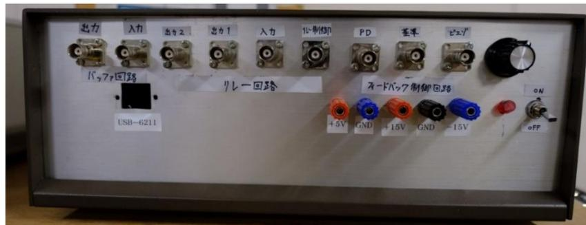
図 2.9 安定化回路, 反転バッファ回路の外観
