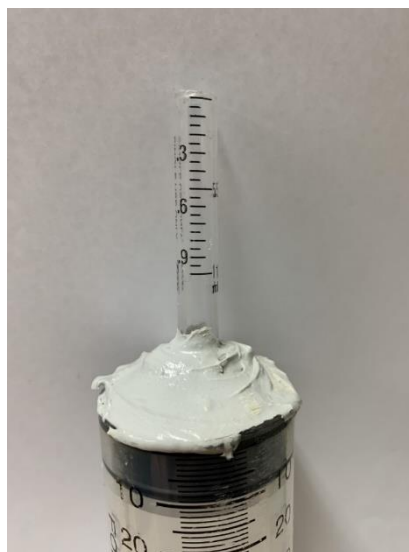
図 5.6 ボイド率の測定に用いた気液混相流を採取する注射器の先端部分
