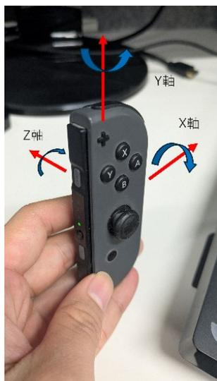
図 1 六軸 IMU センサ
