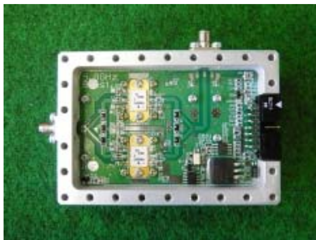
図 4 5.8GHz 帯リニアアンプ Fig.4 5.8GHz-band Linear Amplifier
