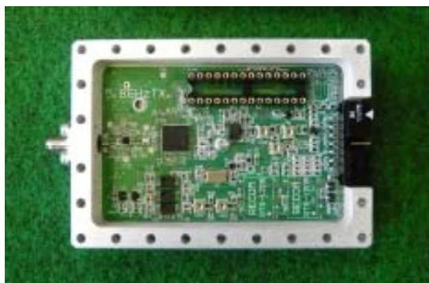
図 2 5.8GHz 帯送信機モジュール Fig.2 5.8GHz-band transmitter module
