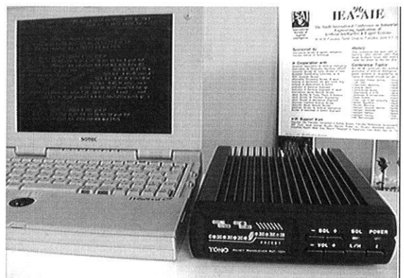
無線IPゲートウェイJA6AVG局(旧型ノートパソコンとPMT-192)
