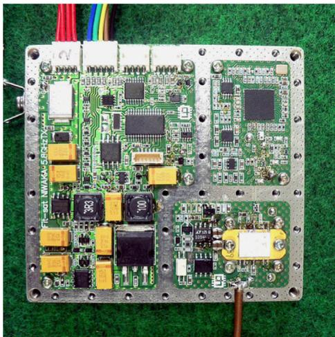
Fig. 18. 5.84 GHz transmitter module.
