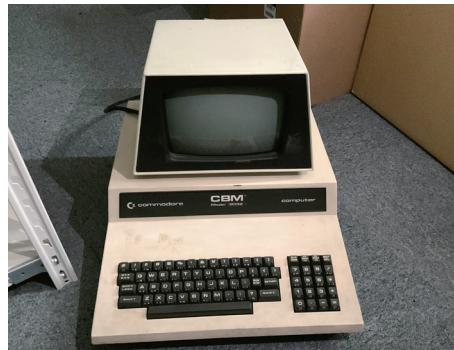
1977年発売のコモドールCBMシリーズは、世界初期の商用パソコンの一つ。初代CBM200IはMOS6502 (1MHz)を搭載し、RAMは4～32KB構成。モノクロCRTディスプレイとデータカセットを一体化し、タイピライター風キーボードを備える。BASICをROM内蔵し、起動直後からプログラミング可能だった。価格は米国で約1,000ドル、日本で約40万円。教育・オフィス向けに普及し、後継シリーズへ発展したビジネスPCの草分け的名機である。
