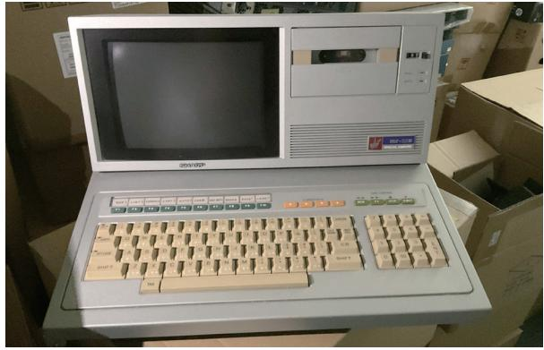
1978年発売のシャープMZ-80は、国産パソコン黎明期を代表する8ビット機。CPUにZilog Z80 (2MHz) を採用し、RAMは20KB (最大48KB) を搭載。モノクロCRTとカセットトレーダーを一体化した設計が特徴で、BASICやアセンブラーを外部テープから読み込む方式を採用。標準価格は約19万8,000円。教育機関やホビーユーザーに広く普及し、自作プログラム文化を育んだ。日本のパソコン発展を支えた画期的モデルである。写真はMZ-80B (1981年発売)。Z80A (4MHz) 搭載、RAM32KB (最大64KB)。グラフィック機能を強化し、BASIC内蔵ROMを搭載。ビジネス用途にも対応。価格298,000円前後。
