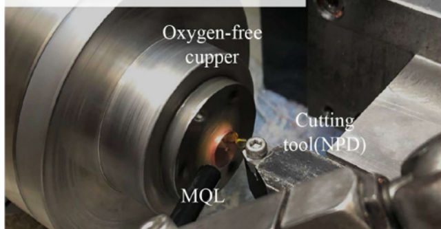
無酸素銅に対する超精密切削実験の様子
