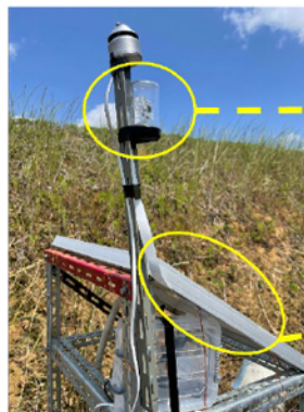
初号機：太陽光と3G回線を利用したシステム
