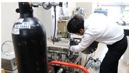
プラズマ発生装置にてトウモロコシ種子に照射
