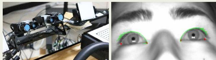
ドライバーの注意力低下の代表的なケースである「居眠り運転」。シミュレーターに設置したカメラでドライバーの顔を撮影。画像をリアルタイムにプログラムで処理し、独自の指標、「開眼率」（上まぶたの閉じ具合を%で表す）を割り出して運転者が居眠り状態に陥っていないか計測する技術を開発しています。この技術で割り出した居眠り運転、集中力低下のリスクも将来的には「POC」に算入することが出来ます。
