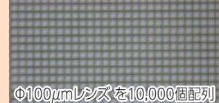
超硬合金製マイクロレンズアレイ (MLA) 金型開発(知能機械工学科・仙波教授／天本准教授)
