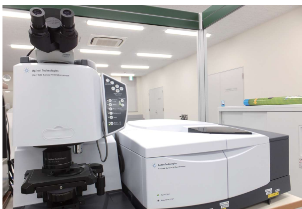
フーリエ変換赤外分光装置 (FT-IR)
