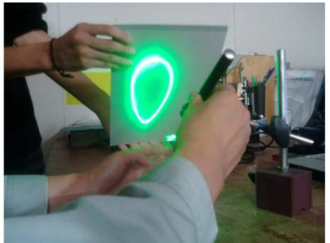
図 28 アームに取り付けたミラーに対して斜め方向からレーザーを当てた場合の軌道
