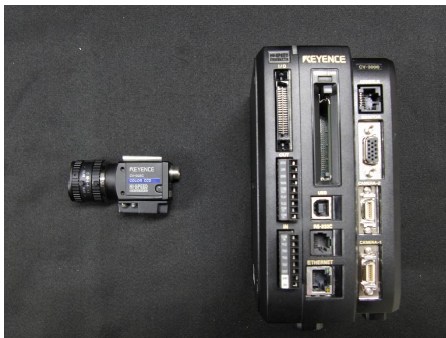
図 4.2-1 CCD カメラ (CV-035C) と画像処理装置 (CV-3000)
