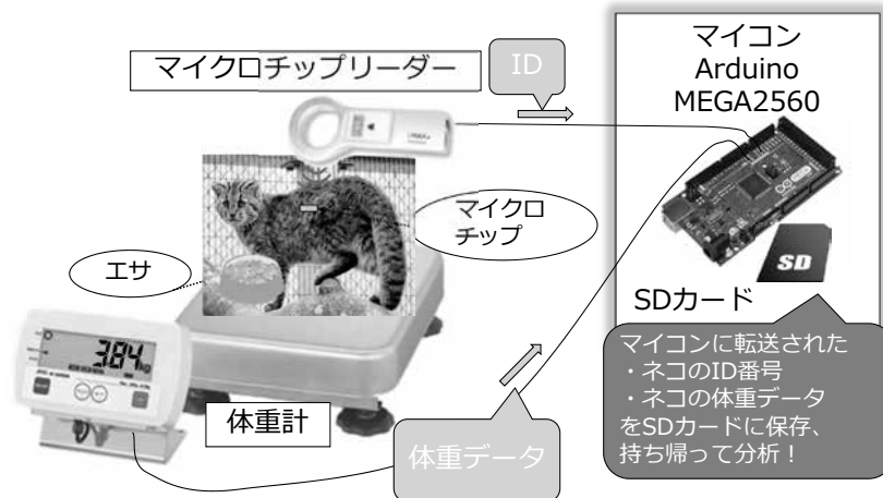
ツシヤママネコの生態調査をするモニタリング装置。ネコが中に入ると、装置上部のマイクロチップリーダーが情報を読み取る
