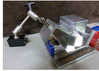
図4 押し操作に対して外乱力を加える実験
