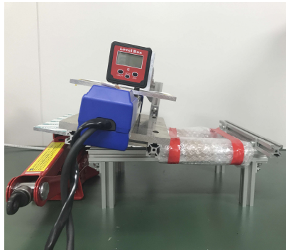
図3 ジャッキを用いて押し操作実験装置全体を傾斜させる
