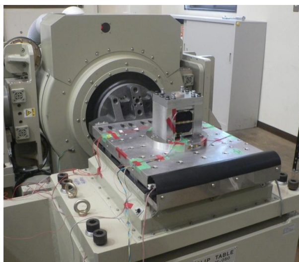
図 11. 九州工業大学超小型衛星試験センターの真相試験装置と FITSAT-1 その他の安全対策
