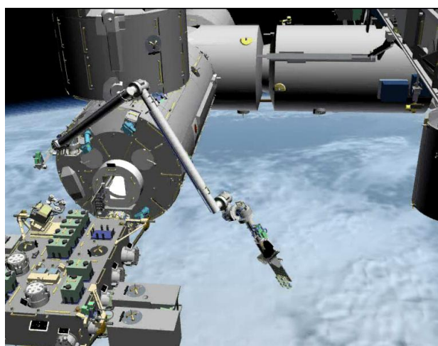
図4. ISS のロボットアームに取り付けられた衛星打出し用コンテナ (JAXA ホームページより転載)
